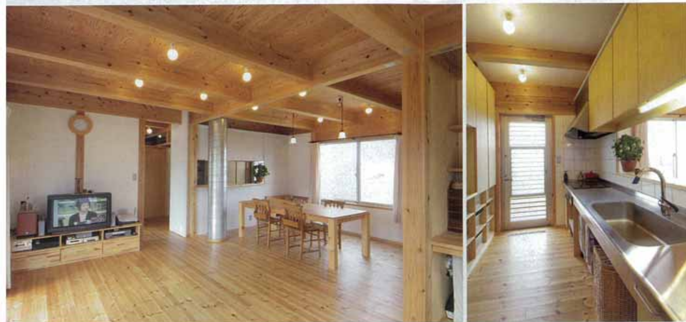
(右)簡素で機能的な「Nキッチン」は、OMソーラー協会のオリジナル(左・下)「実は、主人はひとりであるのが好きじゃないみたいで」と笑顔で話す奥さま。この、どこにいても家族の気配が感じられるオープンなプランを、ご主人がなによりも気に入っているのだとか。OMソーラーの冬モードが作動すると、階段下にあるような床の吹き出し口から暖気が立ち上り、さらに暖気は階段を介して2階へと伝わる。壁や屋根などには断熱材として木質繊維のセルローズファイバーが使われ、外気温に左右されにくい高断熱のつくり
